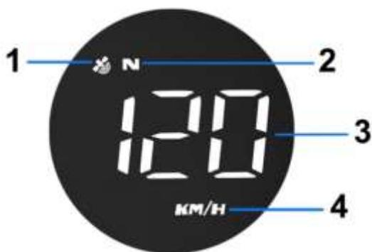
1. Stato del GPS (lampeggiante durante la ricerca del satellite)
